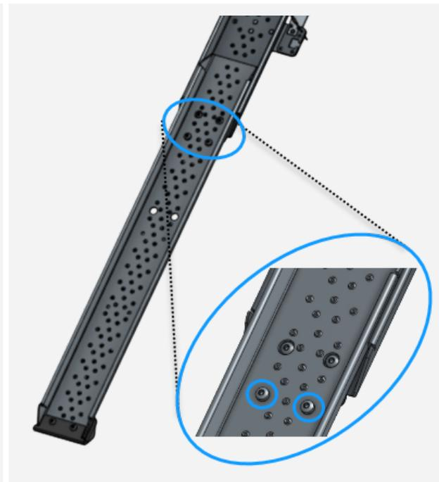
2. Die Base wieder mit dem Scharnier verschrauben. Dazu werden alle im ersten Schritt abmontierten Teile benötigt. Für die mittlere Konfiguration verschraubst Du die Base mit dem Scharnier an der mittleren Position. Achte darauf, dass das Scharnier parallel zur Base ausgerichtet ist. Ziehe die Schrauben mit einem Drehmoment von 4.7 Nm fest an.
