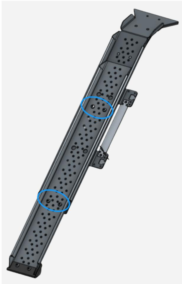
2. Scharnier am Kopf mit zwei M6 x 12 mm Schrauben und zwei M6 Ganzmetall Sicherungsmuttern verschrauben. Achte darauf, dass das Scharnier parallel zum Kopf ausgerichtet ist. Ziehe die Schrauben mit einem Drehmoment von 4.7 Nm fest an.
